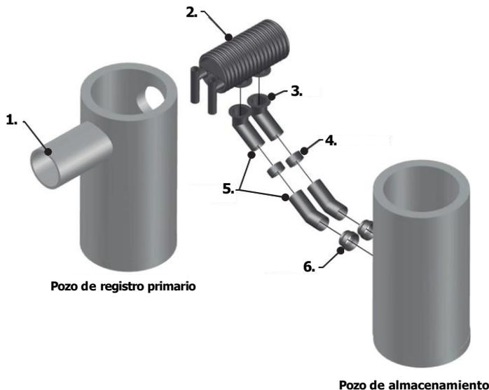
Su función empieza cuando el flujo pluvial contaminado ingresa al sistema por el pozo de registro primario, aquí el sedimento grueso se deposita mientras el flujo pasa sobre un vertedero hacia la unidad **BaySeparator®** y se dirige al pozo de almacenamiento.
